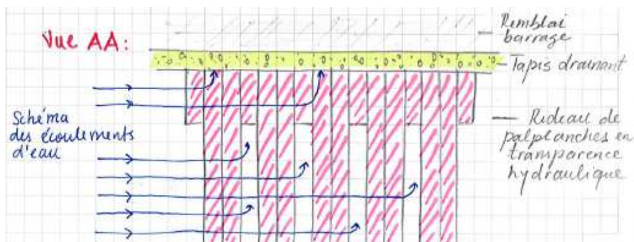
Figure 25. Schéma de principe du rideau de palplanches en transparence hydraulique
